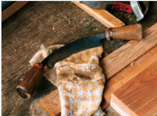
桶屋にある特殊な道具。木を削り湾曲を造る為の鉋（カンナ）、側板の内外に曲面を造る銚（せん）、など。それらを用いて、角度をつけて削っていき最終的に円形に納める。
