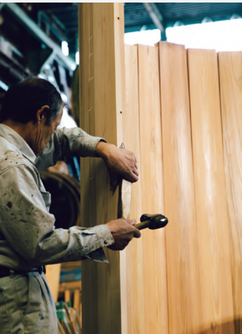
桶屋にある特殊な道具。木を削り湾曲を造る為の鉋（カンナ）、側板の内外に曲面を造る銚（せん）、など。それらを用いて、角度をつけて削っていき最終的に円形に納める。
